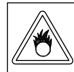
¡PELIGRO! MATERIAL COMBURENTE
