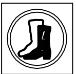
PROTECCION OBLIGATORIA DE LOS PIES (BOTAS DIELECTRICAS)
