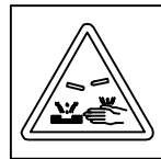
RIESGO DE CORROSION SUSTANCIAS CORROSIVAS
