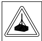
¡PELIGRO! CARGAS SUSPENDIDAS
