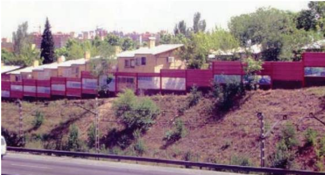
Ejemplo de pantallas acústicas a utilizar en los límites de las parcelas afectadas.
